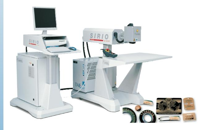
Die Laser der **Serie SIRIO** sind Gravurlasersysteme mit einem zweiachsigen galvanometrischen Abtastkopf, ausgestattet mit einer Diodenlaserquelle im festen Zustand ND:YAG (von 5 bis 150 Watt), die zu Markierungen und Gravierungen von folgenden Materialien eingesetzt werden kann: Buntglas, schwarzer Granit, Aluminium, Metall, Plastik usw.
