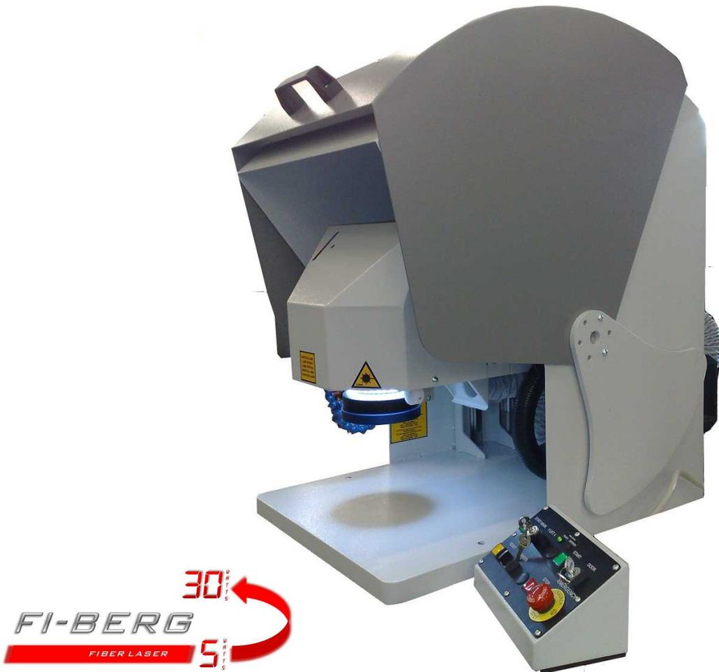
Die Laser der **FI-BERG** Serie sind ausgestattet mit einem galvanometrischen Abtastkopf mit FIBER YTTERBIUM Quelle. Durch das kompakte Design mit seinen geringen Abmaßen wird die Maschine sehr platzsparend eingesetzt. Die Laserquelle kann von 5 bis 30 Watt geliefert werden und erlaubt so einen weiten Produktionsbereich, vor allem auf Metall. Ein Notebook ist im Lieferumfang enthalten.
